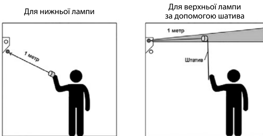
Малюнок 1. Схема розташування датчика ультрафіолетового радіометра
